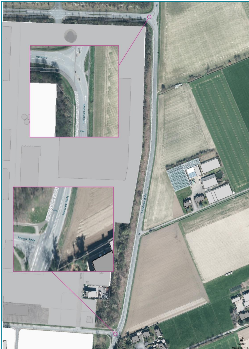
Bild 40: Gestaltungsvorschlag für die Anlage eines gemeinsamen Geh-Radweges an der Scheidinger Straße (Quelle: eigene Darstellung)
