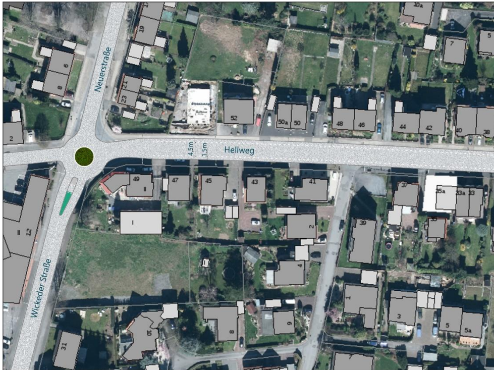
Bild 36: Gestaltungsvorschlag zur Umgestaltung des Knotenpunktes Sankt-Georg-Straße / Hellweg / Wickeder Straße und des anschließenden Hellwegs (Quelle: eigene Darstellung)
