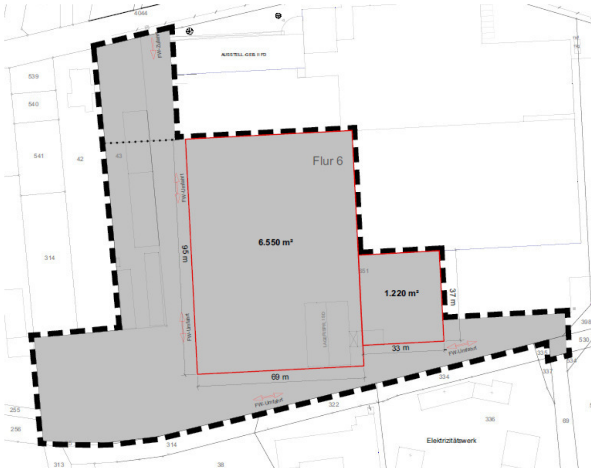
Abb. 7: Maße des Hochregallagers (Quelle: eigene Darstellung)
